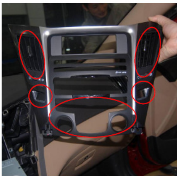
Extraer: 1.- Rejillas de Ventilación 2.- Lampara emergencia 3.- Panel Control Aire.
